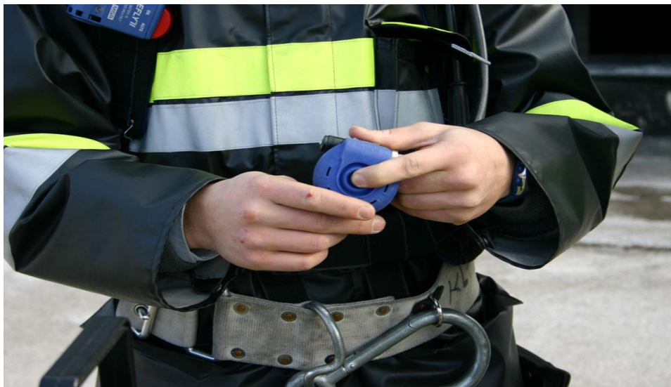
Abb.: Betätigen des Duschknopfes am Lungenautomat
