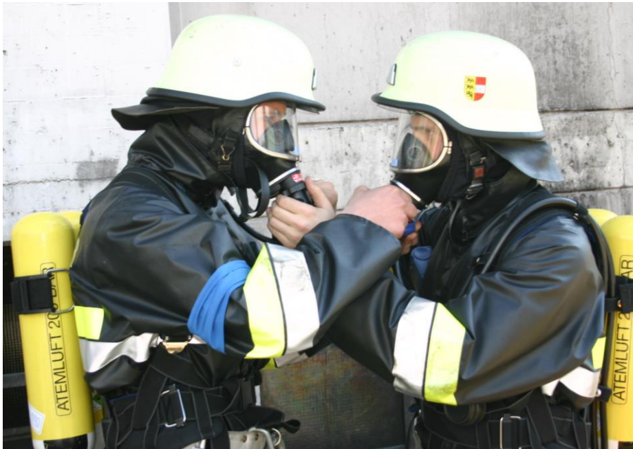
Abb.: Anschließen des Lungenautomaten
