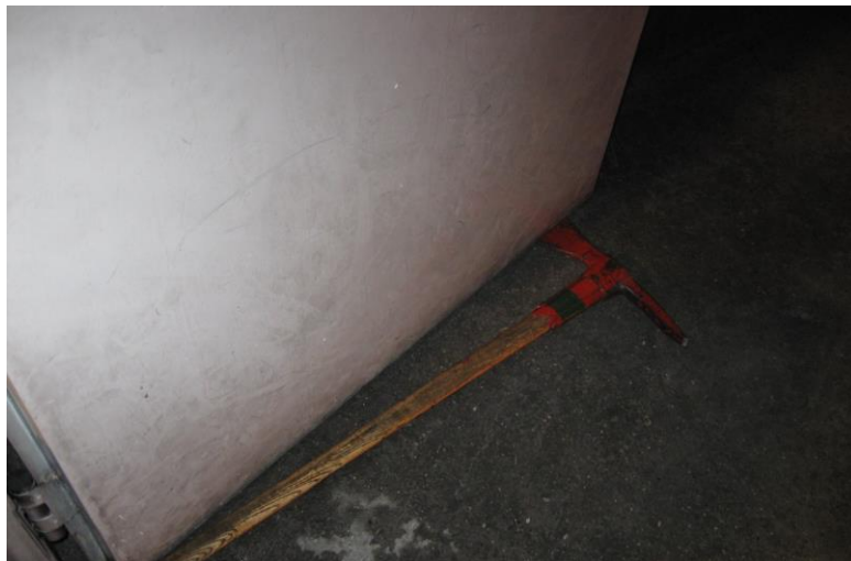
Abb.: Aufkeilen der Türe mittels Feuerwehrraxt
