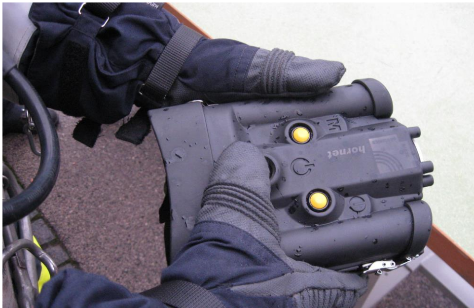
Abb.: Einschalten der Wärmebildkamera durch den ASTRF
